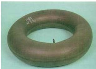
El neumático se componen de **cubierta y cámara, alojan en ésta el aire.**
