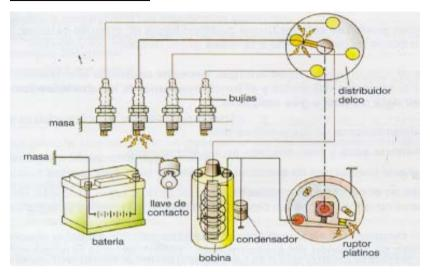
Para que la chispa salte en la bujía en el momento oportuno, se necesita el circuito de encendido, con los siguientes elementos:
