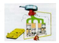
Una válvula de mariposa accionada por el conductor **a través del pedal de acelerador dosifica** la succión de los pistones y, por tanto, **la cantidad de mezcla que entra a cilindro**.
