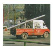
Las cargas de longitud indivisible como vigas, postes o tubos pueden sobresalir longitudinalmente de la proyección del vehículo, siempre que no se supere la longitud máxima establecida y no ponga en riesgo, la seguridad de los usuarios en la vía, la misma que es considerada para la expedición del permiso correspondiente.
