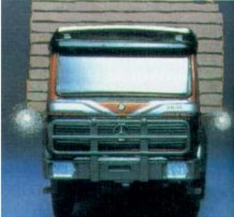
Debe ser **visible de noche**, en condiciones de visibilidad normales, a **una distancia mínima** de 100 metros, tanto por delante como por detrás. Sus bordes exteriores deben estar situados tan cerca como sea posible de los bordes exteriores del vehículo.
